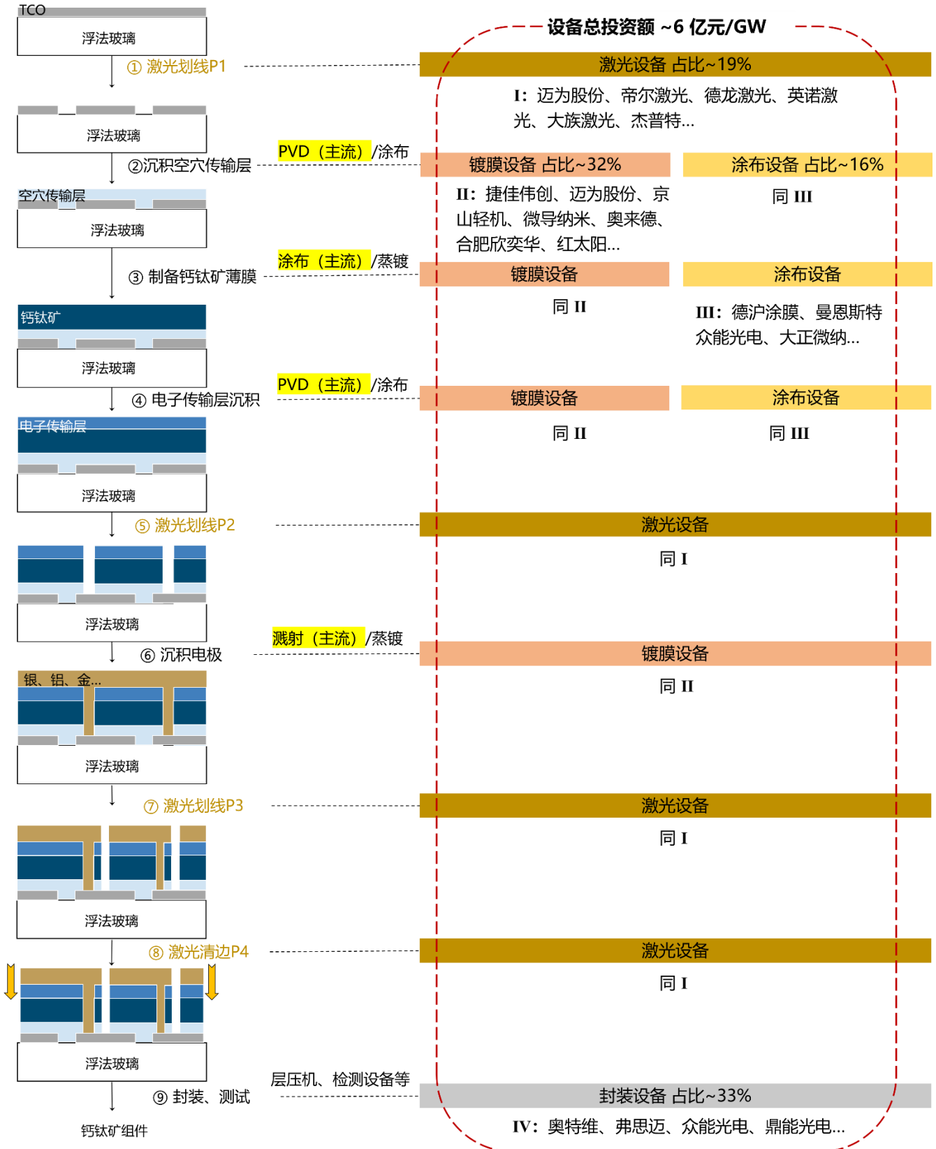
图表16：单结钙钛矿电池工艺流程（以反型结构为例）
